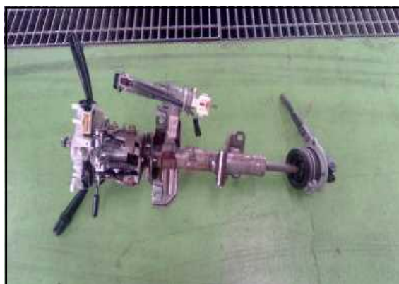
外したステアリング装置
