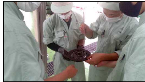
クラッチフェーシングの摩耗測定
