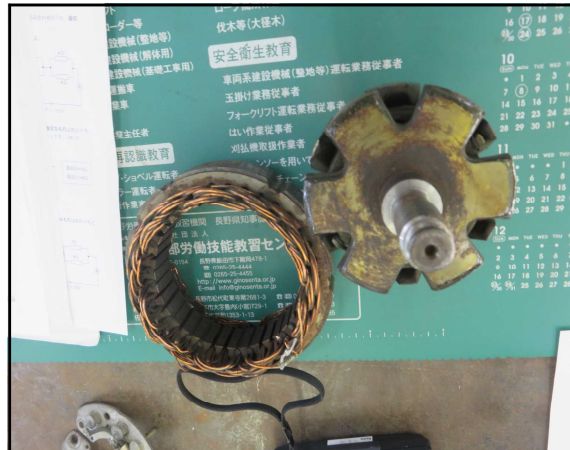
発電するステータ(左)とローター(右)
