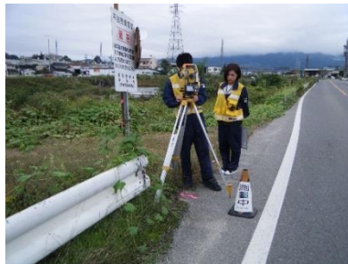
T S(トータルステーション) での測角・測距
