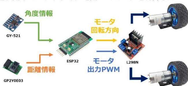
図3 使用部品・回路概要図
