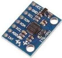
TDK InvenSense 製の MPU-6050 チップを搭載したユニット .I2C で通信ができ、安価でコンパクト
