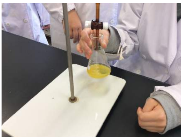
硝酸銀試薬で滴定します。 赤い沈殿ができたなら滴定終了。
