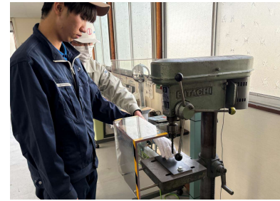
図6 改良版ボール盤 巻き込まれ装置
