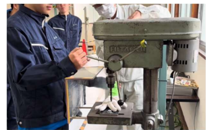
図3 ボール盤巻き込まれ装置
