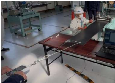
図4 改良版ベルトコンベア まきこまれ装置
