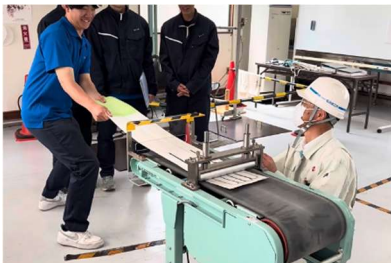
図1 ベルトコンベア巻き込まれ装置
