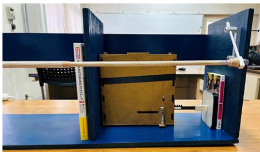
図8 完成した耐震自動ブックエンド
