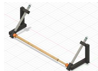
図4 スライド入力の揺動機構
