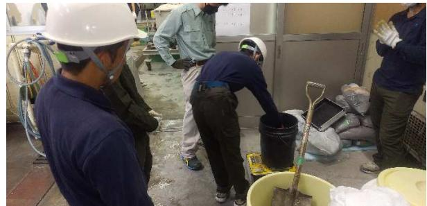
コンクリートの強度試験用供試体の体験
