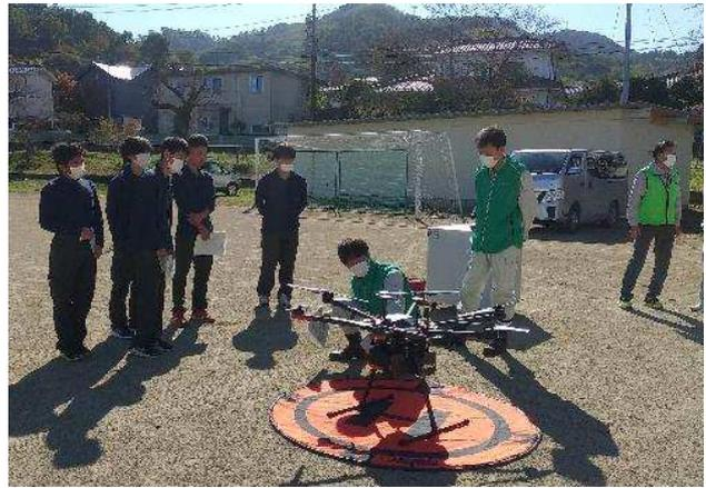
UAV 搭載 3次元レーザースキャナ
