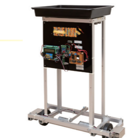
課題研究 「倒立二輪ロボットによる搬送テーブルの製作」
