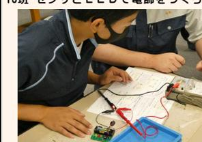
光センサとLEDについて実験を通して特性を学習します。次に部品やマイコンをプリント基板にハンダ付けして、周囲が暗くなると点滅する電飾を製作します。7班、8班、13班はマイコン制御技術を活用します。
