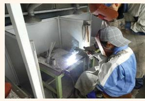
アーク溶接という技術を使ってベンスタントを作ります。金属に大きな電圧を加え放電させることで、接続部分を溶かして金属同士をくっつけます。溶接時に数千℃ものアーク放電や強い光が発生します。
