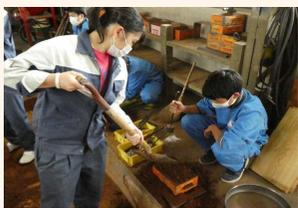
鋳造(ちゅうぞう)という技術を使って表札を作ります。熱して溶かしたアルミを型に流し込み、冷やして形を作ります。溶かしたアルミは700℃という高温になります。700℃の世界を実感して下さい。
