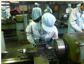
機械系は金属を加工して文鎮を作ります。写真は旋盤という機械を使って金属の丸棒を削っています。
