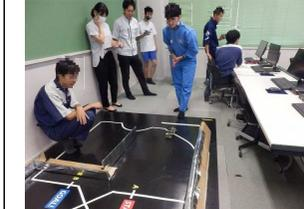
障害物にぶつからないプログラムをパソコンで制作して、マイコンカーを走らせます。
