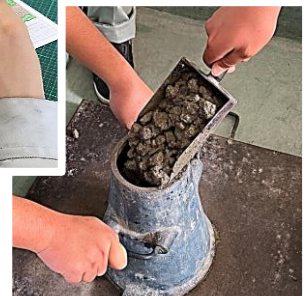
材料実習（スランプ試験）
