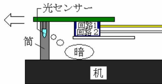
本体が左側に移動していくと、筒が机の外に出る。
