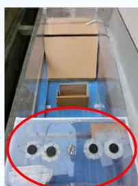
掃除機で容器内の空気を吸い、水をため込み栓を抜くことで造波させる。
