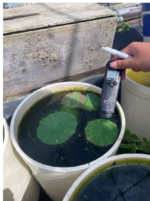
測定の様子 (電気伝導度・水素イオン濃度)
