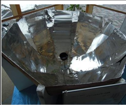
直径190cmのソーラークッカー ※ソーラークッカーとは、太陽光を利用した調理具
