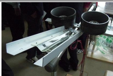
手軽なバッテリーマシン 球種を変えられるようプログラム制御されている
